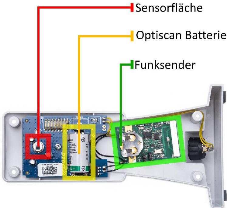
Auf der grossen Platine sehen Sie die Batterie für den Optiscan selbst.
